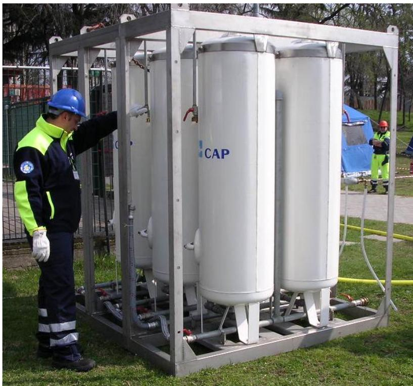
L'impianto modulare viene stoccato presso le sedi di Rozzano o di Paderno a seconda della sede più idonea al rientro da attività che ne hanno comportato l'utilizzo; il quantitativo (1,70 m<sup>3</sup>) di carbone attivo granulare necessario all'attivazione dell'impianto di filtrazione avviene mediante richiesta di approvvigionamento da parte della Struttura Pronto Intervento mediante ordine in urgenza alla società aggiudicatrice l'appalto di fornitura carboni.
