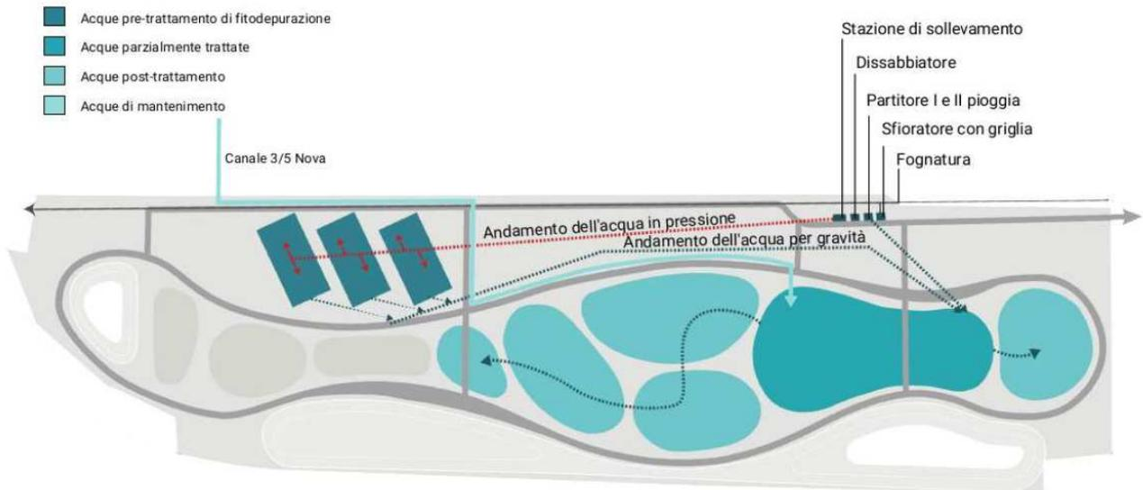
Figura 1 – Planimetria funzionale delle opere idrauliche in progetto
