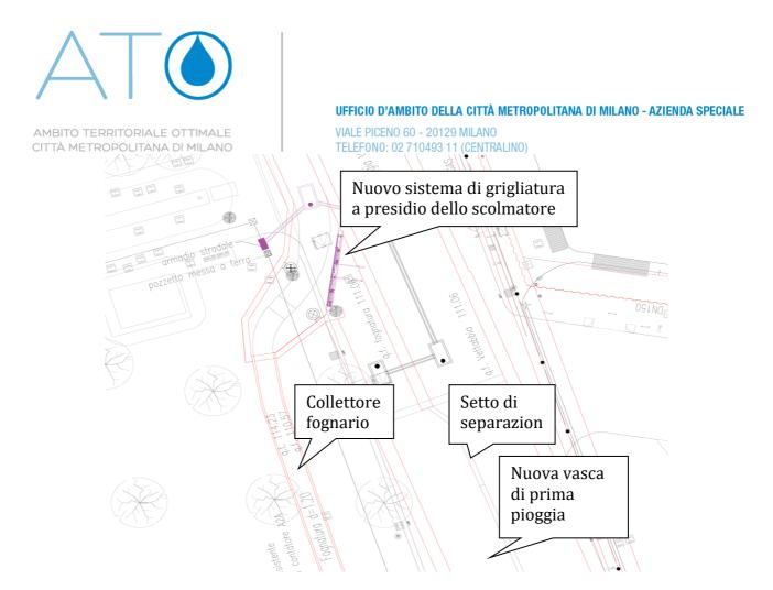
Intervento 2100N – stato di progetto: particolare del manufatto di sfioratore a seguito dell'intervento di adeguamento e della porzione di monte della vasca di prima pioggia ricavata all'interno dell'alveo della Roggia Vettabbia.
