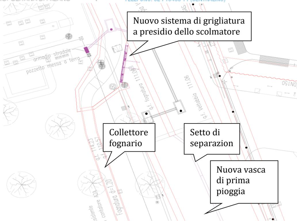
Intervento 2100N – stato di progetto: particolare del manufatto di sfioratore a seguito dell'intervento di adeguamento e della porzione di monte della vasca di prima pioggia ricavata all'interno dell'alveo della Roggia Vettabbia.
